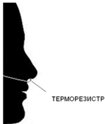
**Рисунок 1. Размещение чувствительного элемента (терморезистора) Приборно-программного комплекса (ППК)**
