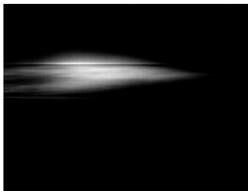
Рис. 1 Фотография пучка филаментов, созданного фемтосекундными лазерными импульсами с энергиями 6.6 мДж, при увеличении 10×
