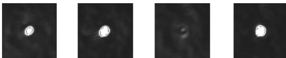
Рис. 3. Фотографии зависимости сечения пучка в главном фокусе дифракционного элемента от напряжения. Слева направо: 0В, 1В, 1,67В, 5В
