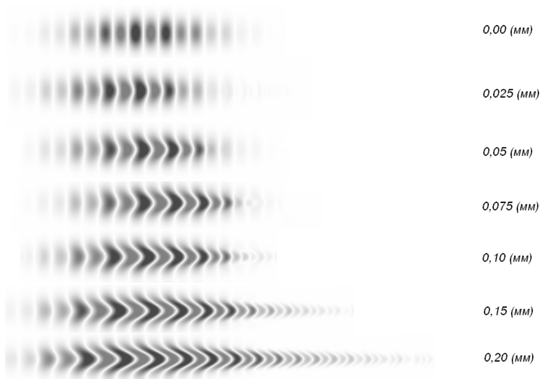
Рис.3. Пространственно-временная эволюция электрического поля фемтосекундного светового импульса из нескольких колебаний с входными пространственно-временными параметрами: \lambda = 780 нм, r = 500\lambda и \tau = 7,5 фс, I = 1,5 \cdot 10^{13} Вт/см 2 по мере распространения в кварцевом стекле на расстояния 0,0; 0,05; 0,10; 0,15; 0,20 мм.
