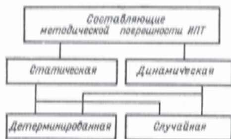
Рис. 3.2. Составляющие методической погрешности на выходе ИПТ
