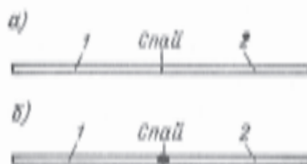
Рис. 6.10. Проволочные термопары: а — бескорольковая термопара; б — термопара со сферическим «корольком» (термоспаем) 1 и 2 — термоэлектроды
