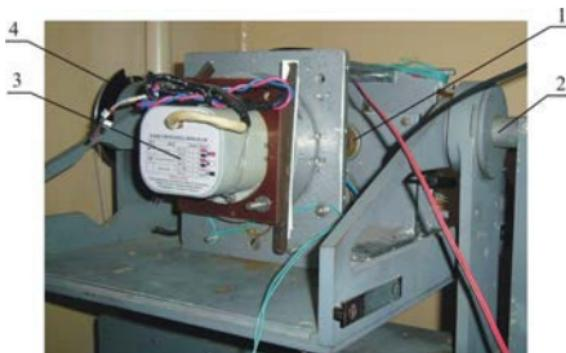
Рис 3 Общий вид стенда: 1 – привод вращения по крену; 2 – привод колебаний по поперечной оси; 3 – блок 303МАВ-150; 4 – потенциометрический датчик угла стенда
