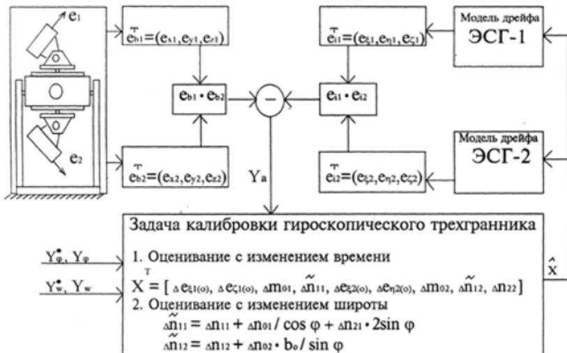
Рис. 1. Калибровка погрешностей гироскопического трехгранника в ИНС (A)
