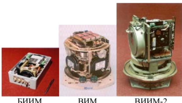
Рис. 2. Инерциальные измерительные модули разработки на волоконно-оптических гироскопах
