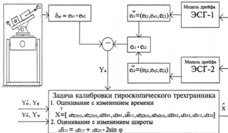
Рис. 2. Калибровка погрешностей гироскопического трехгранника в ИНС (B)
