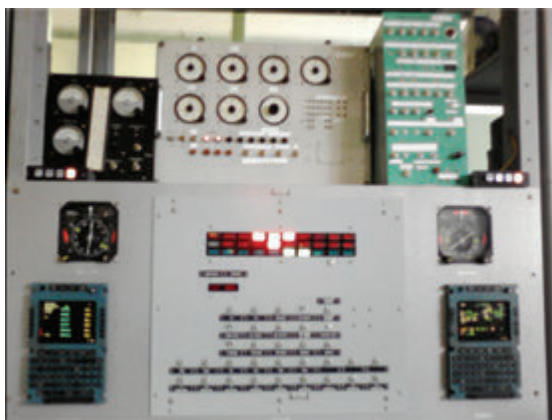
Рис. 19. Стенд проверки комплексов объекта Ан-74. 2004 год
